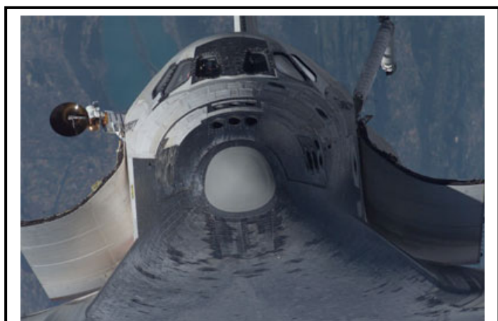
Lo Shuttle Discovery ripreso dalla Stazione Internazionale durante la piroetta per verificare lo stato delle piastrelle ceramiche (fonte: NASA)
